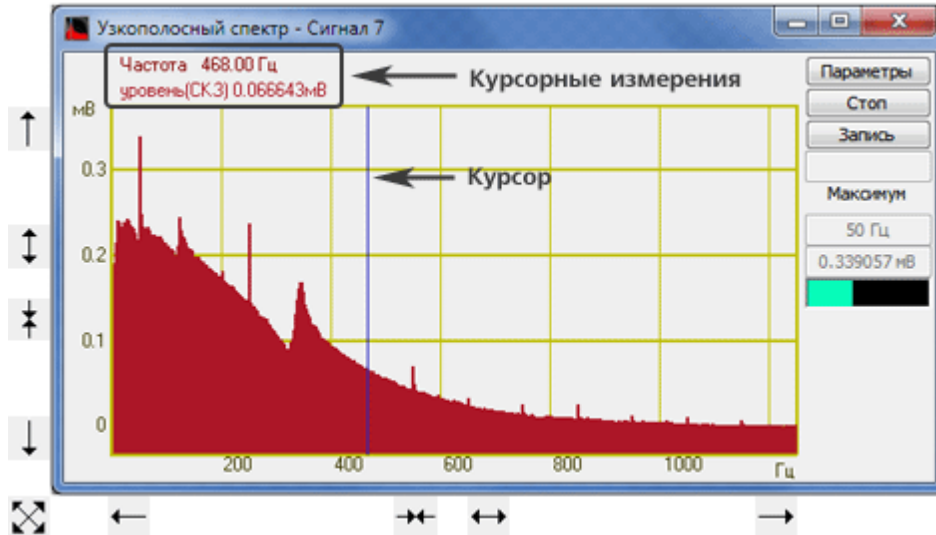
Узкополосный спектр, управление курсором и масштабирование графиков
