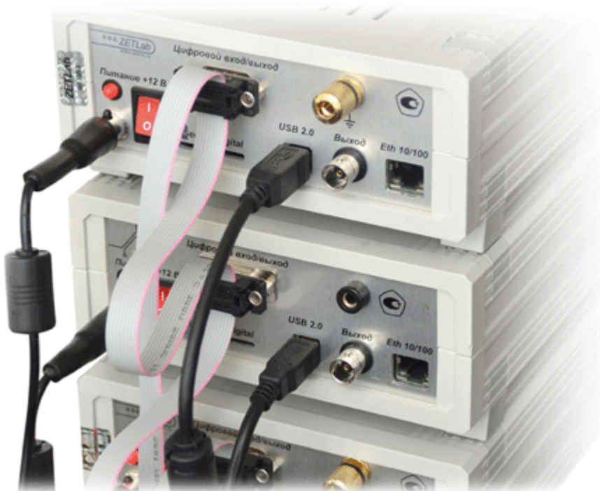
Синхронизация анализаторов спектра по цифровому порту
