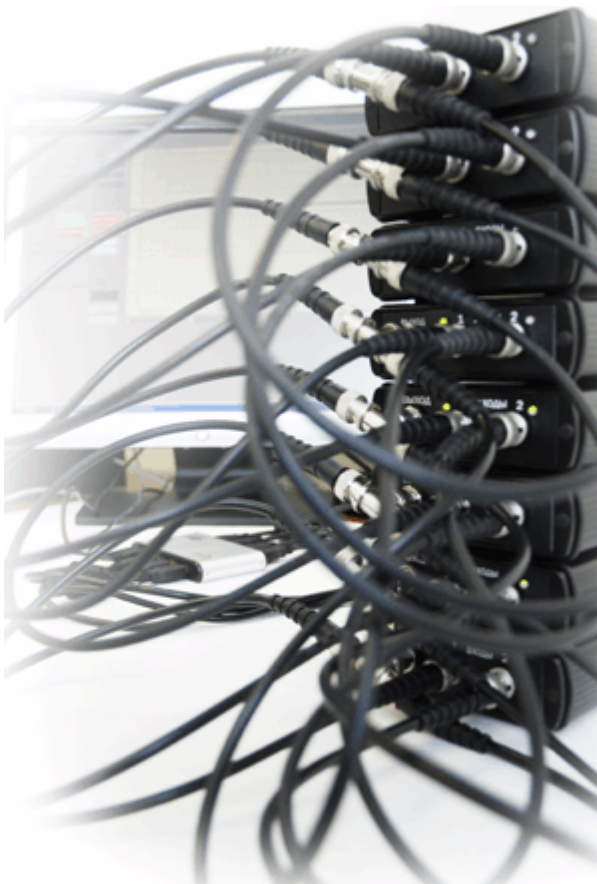
Многоканальная система на базе анализаторов спектра
