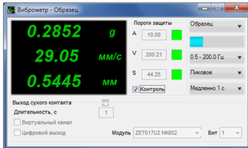
Виброметр с элементами порогового контроля
