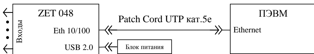
Рисунок 1.6 – подключение регистратора ZET 048-С и ZET 048-И к ПЭВМ по интерфейсу Ethernet с питанием от внешнего источника
