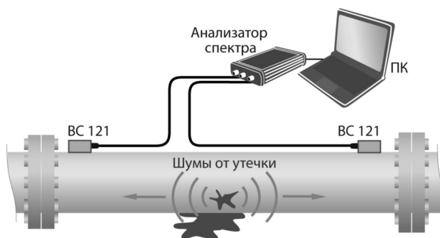
Обнаружение и локализация утечки коррелятором ZET 017 и датчиками BC 121
