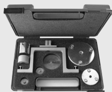
Комплект крепёжных приспособлений (для установки датчиков на калибровочный стенд).
