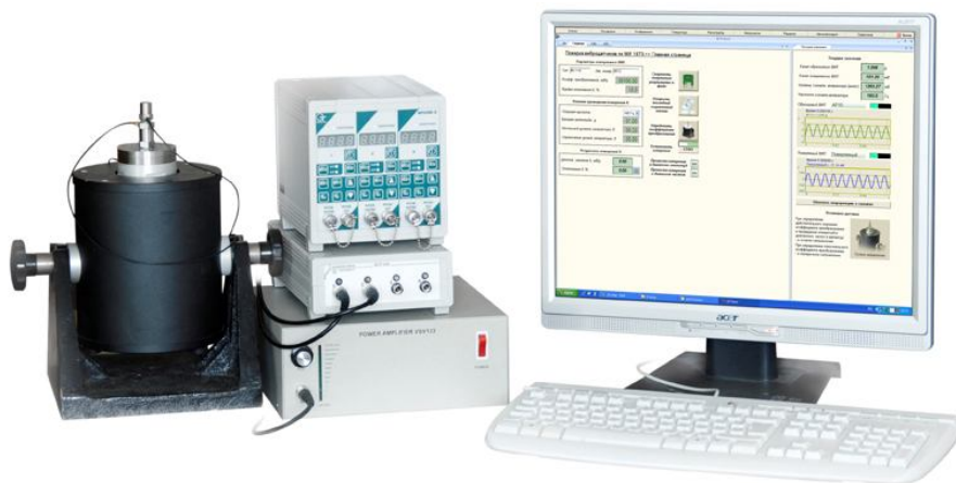
Рисунок 3.1 – Состав аппаратуры для проведения поверки вибропреобразователей
