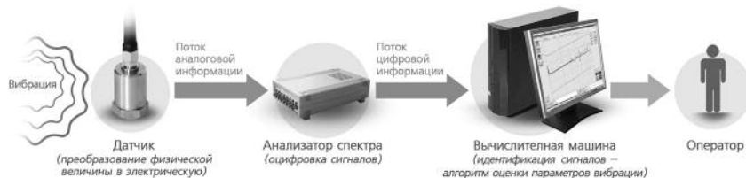
Рис. 2. Схема прохождения данных от датчика до верхнего оператора АРМ в лаборатории вибродиагностики
