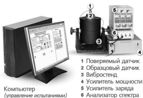
Рис. 6. Система поверки акселерометров на базе виброустановки BC-133 и анализатора спектра ZET017
