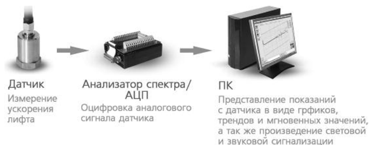
Рис. 5. Упрощенная функциональная схема АПК
