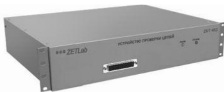
Рис. 18. Автоматизированный стенд «Устройство контроля электрических цепей»
