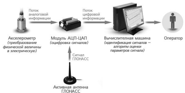
Рис. 14. Упрощенная схема аппаратно-программного комплекса
