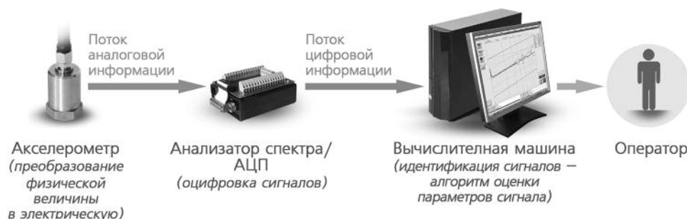
Рис. 1. Поток информации с нижнего уровня датчиков до верхнего уровня оператора
