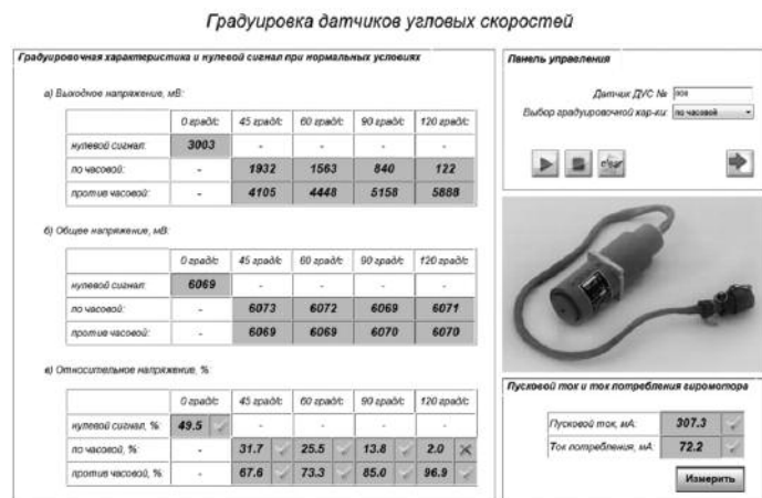
Рис. 7. Автоматизированный стенд «Калибровка датчиков угловых скоростей». Интерфейс оператора
