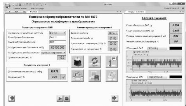
Рис. 7. Пример проекта поверки вибропреобразователей по МИ 1873 в автоматическом режиме.
