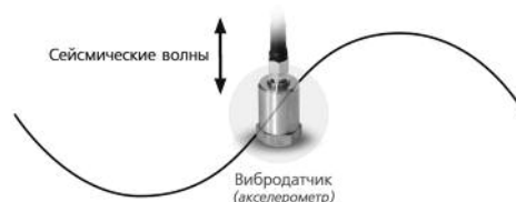
Рис. 3. Распространение поперечных волн колебаний
