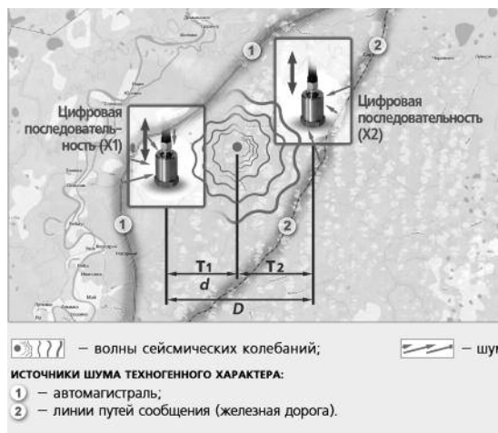
Рис. 4. Схема эксперимента, приближенного к реальным условиям
