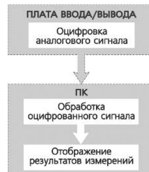
Рис. 2. Структурная схема виртуального прибора
