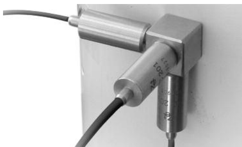
Рис. 3а. Способ крепления акселерометров серии ZET BC201
