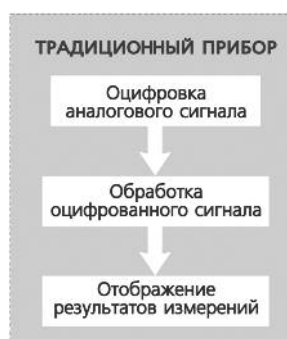
Рис. 1. Структурная схема автономного измерительного устройства
