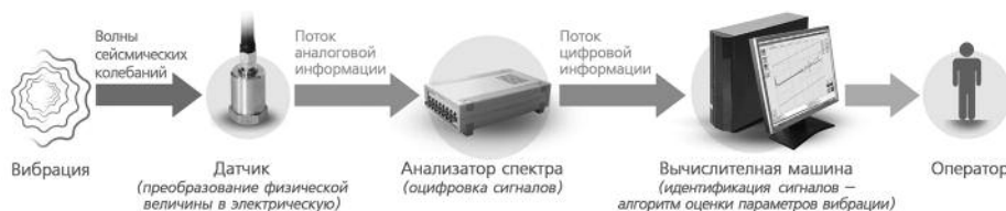
Рис. 1. Блок-диаграмма прохождения данных в системе
