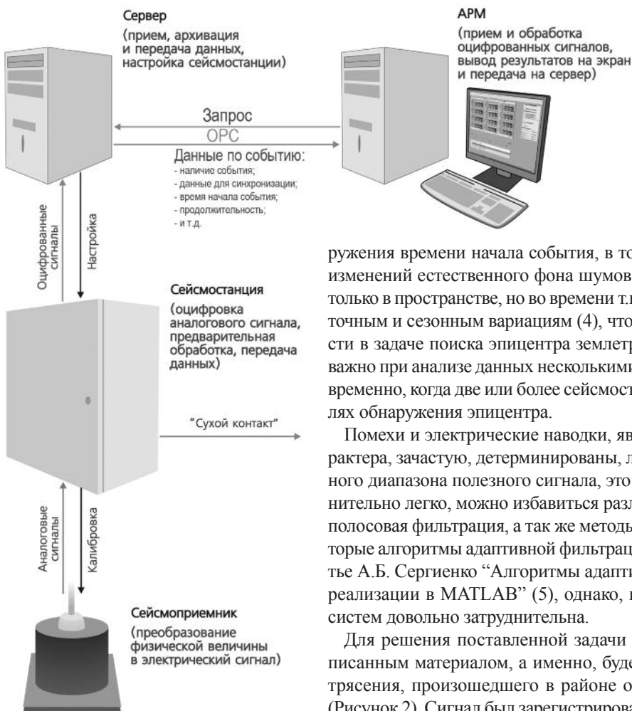
Рис. 3. Схема регистрации сейсмического сигнала и передачи на вычислитель (ПК, производящий математическую обработку сигнала)
