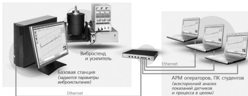
Рис. 1. Функциональная схема распределенной системы автоматического управления и контроля в лаборатории ВУЗа
