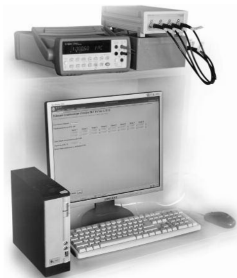
Рис. 9. Автоматизированный стенд «Поверка анализатора спектра». Аппаратная часть
