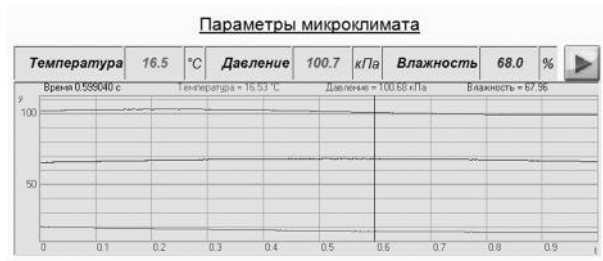
Рис. 5. SCADA-проект «Управление микроклиматом», интерфейс оператора
