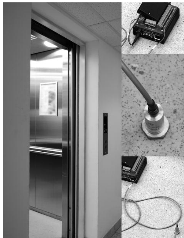
Рис. 3в. Подготовка к измерениям: установка датчика BC201 и модуля АЦП-ЦАП ZET220 в кабине лифта
