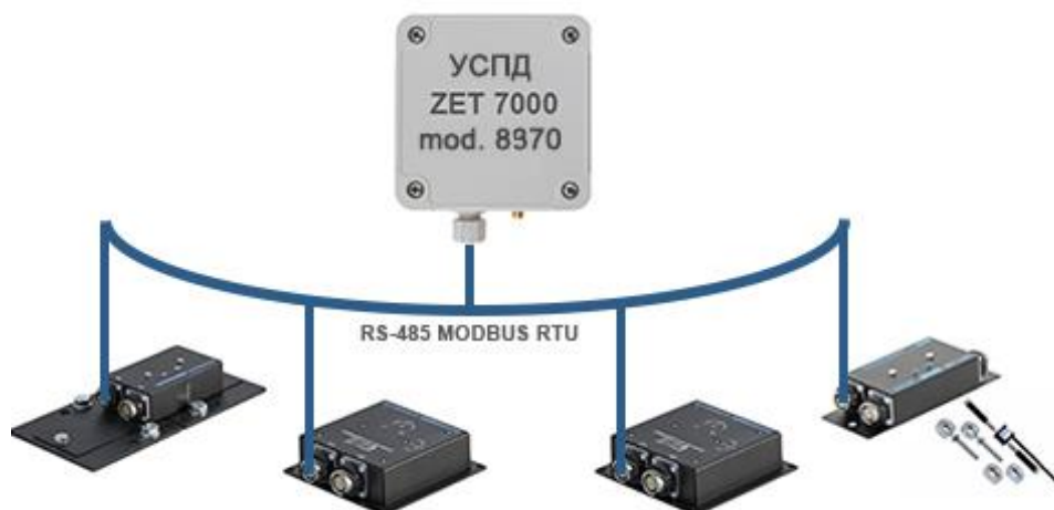
Рис. 4.1 Схема подключения при построении измерительной линии
