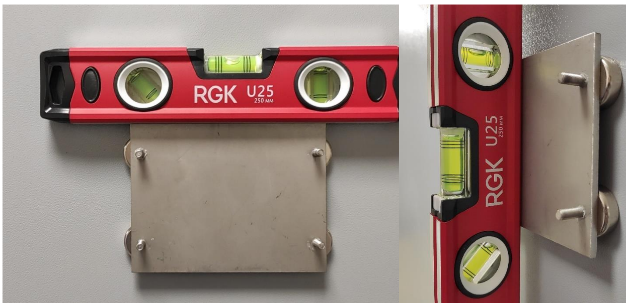
Рис. 5.2 Выравнивание горизонта установки пластины при помощи строительного уровня
