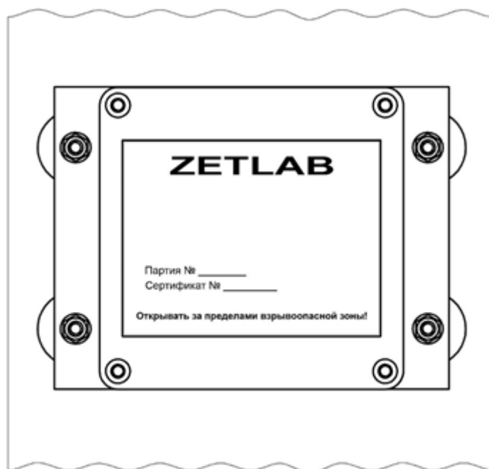
Рис. 3.3 Крепление регистратора на вертикальную поверхность
