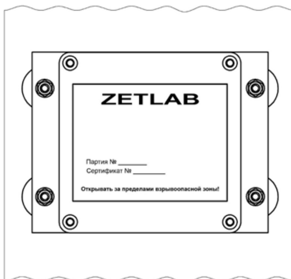
Рис. 4.2 Крепление датчика на вертикальную поверхность
