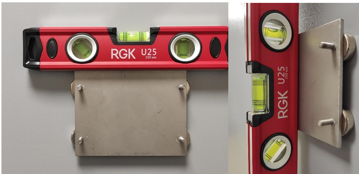
Рис. 3.2 Выравнивание горизонта установки пластины при помощи строительного уровня
