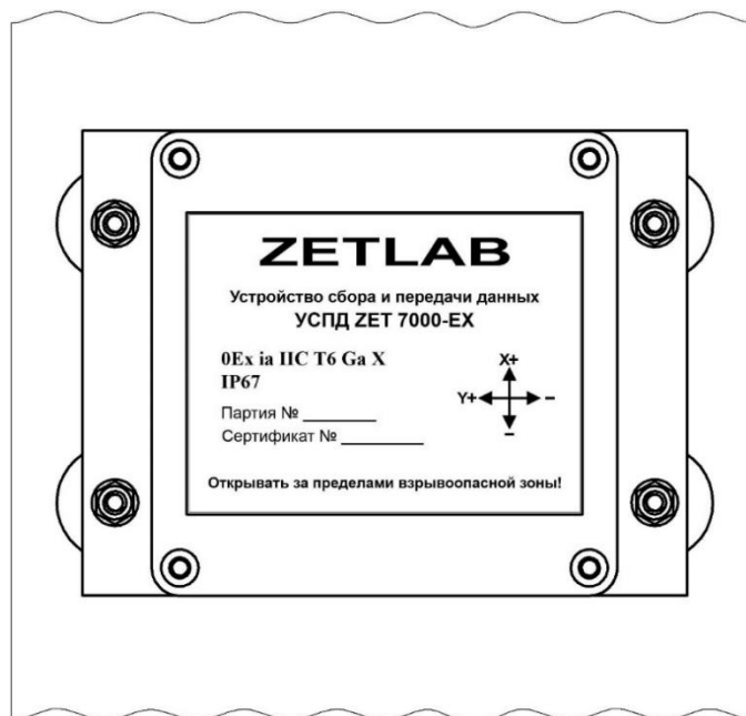
Рис. 5.3 Крепление инклинометра на вертикальную поверхность
