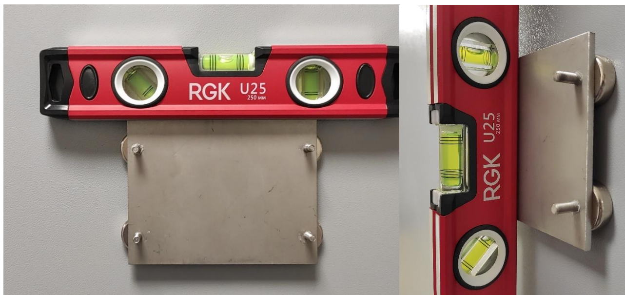
Рис. 5.2 Выравнивание горизонта установки пластины при помощи строительного уровня
