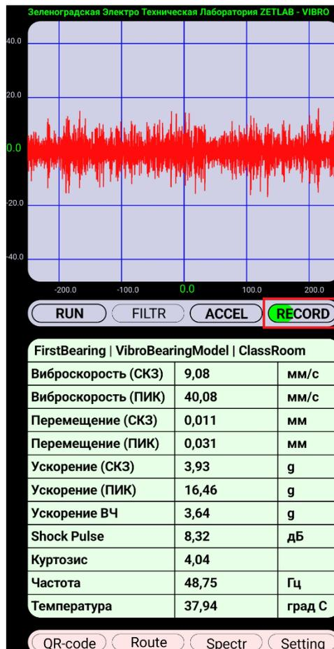
Рис. 4.3 Регистрация сигнала ускорения
