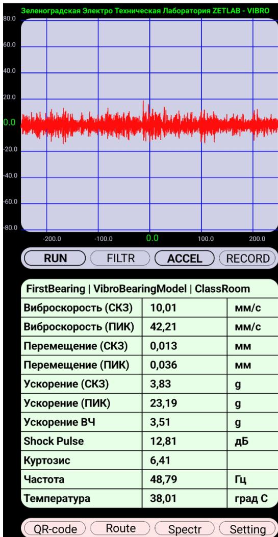
Рис. 3.3 Режиме экрана осциллограммы
