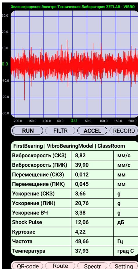
Рис. 4.1 Режиме экрана осциллограммы
