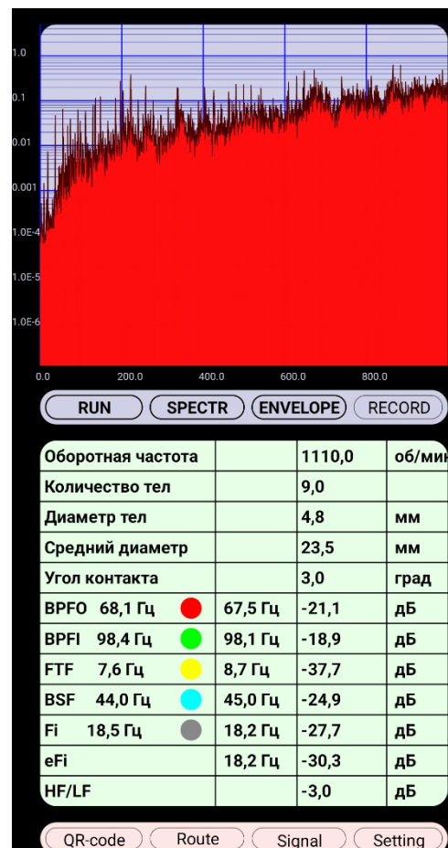
Рис. 4.2 Режим экрана спектра
