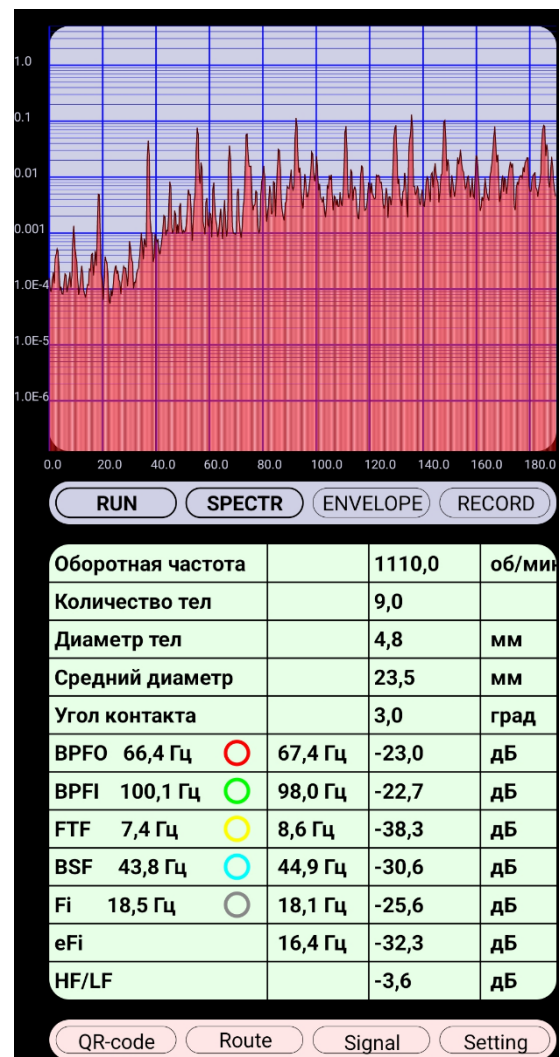
Рис. 3.4 Режим экрана спектра
