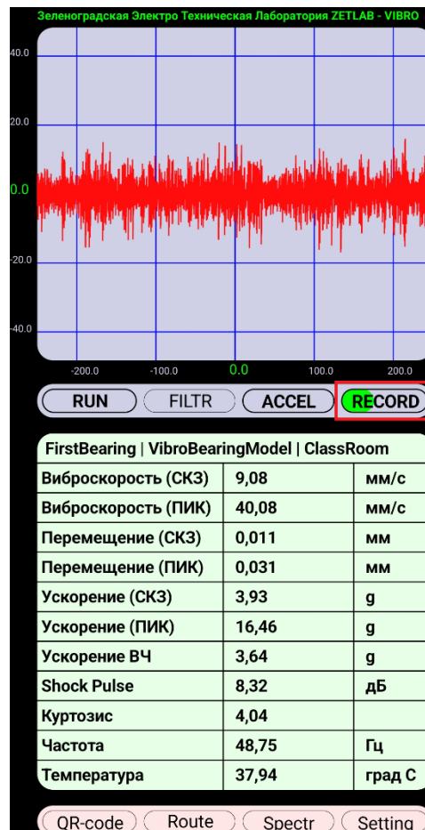
Рис. 4.3 Регистрация сигнала ускорения
