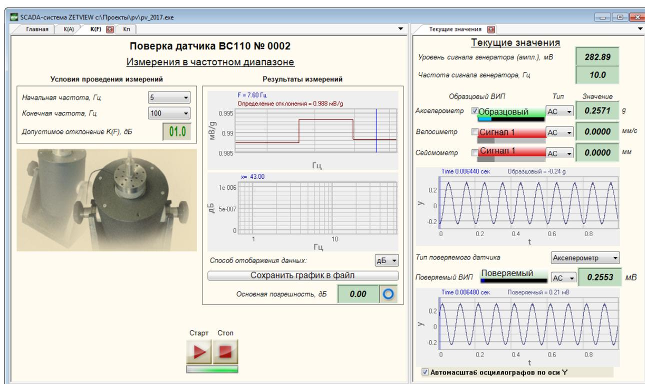
Рисунок 35 – Измерения в частотном диапазоне
