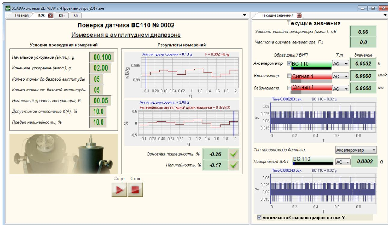
Рисунок 13 – Измерения в амплитудном диапазоне
