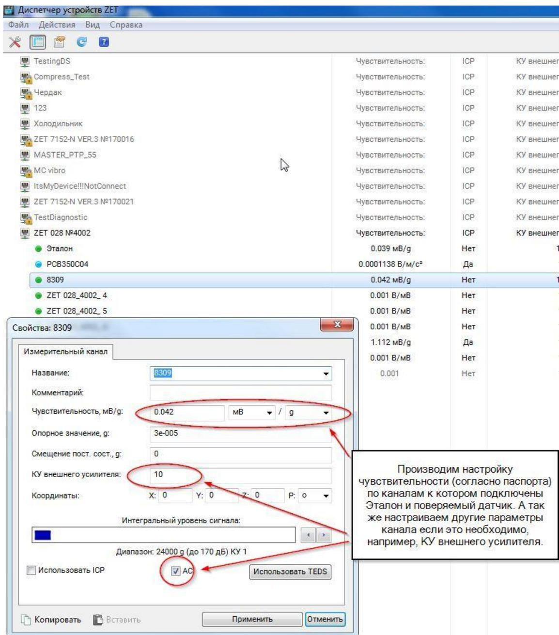
Рисунок 45 - Настройка эталонного и поверяемого канала
