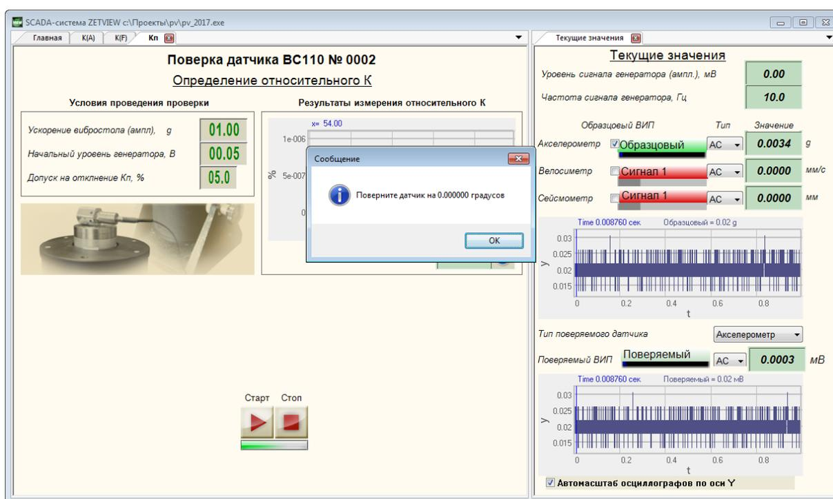
Рисунок 38 – Измерения коэффициента преобразования в поперечном направлении
