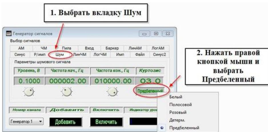
Рисунок 43 - Настройка генератора сигналов
