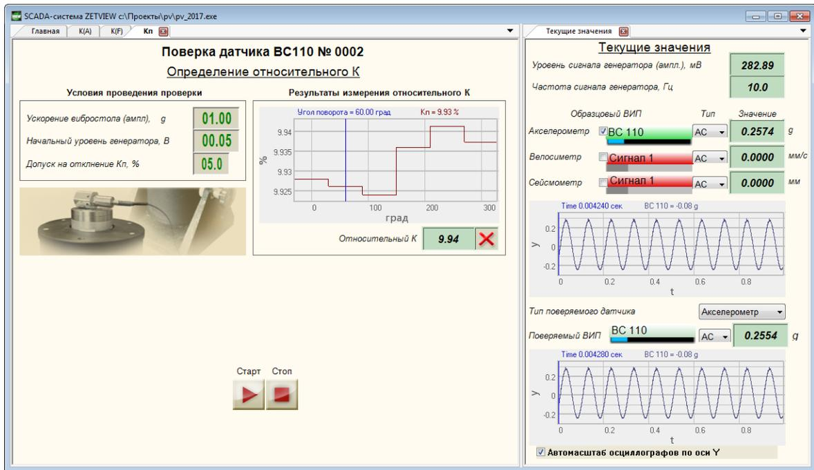
Рисунок 39 – Результат измерений коэффициента преобразования в поперечном направлении
