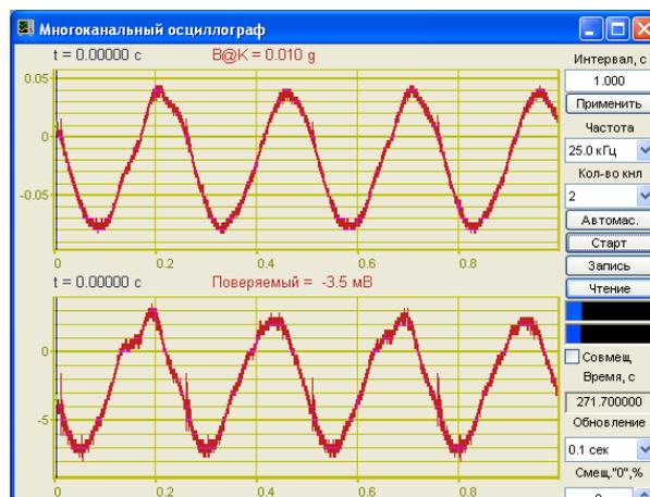
Рисунок 3. Искажение формы сигнала
