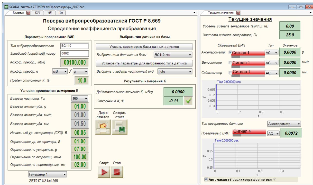
Рисунок 6 – Программа проверки вибропреобразователей, страницы «Главная» и «Текущие значения»
