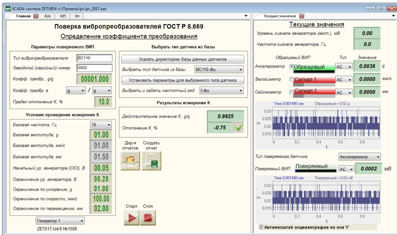
Рисунок 32. Результат измерений коэффициента преобразования.
