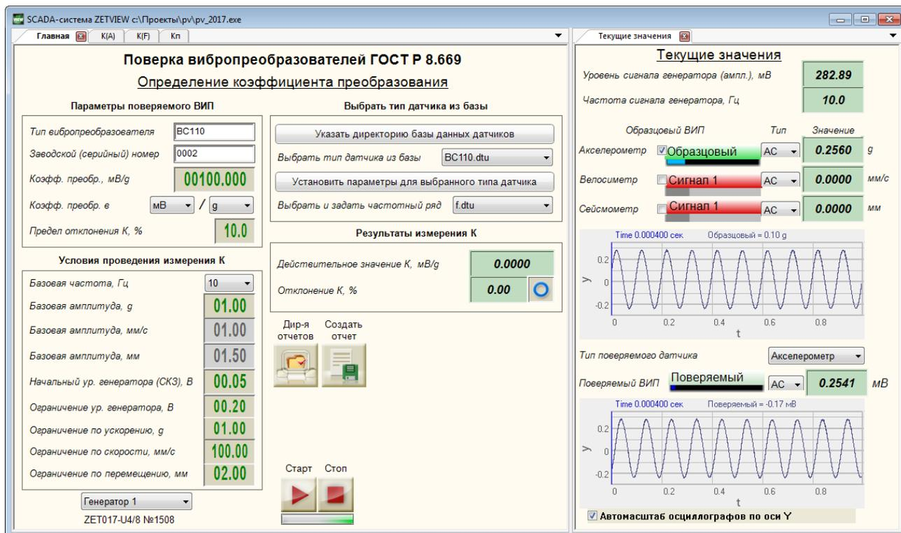
Рисунок 31 – Определение действительного значения коэффициента преобразования
