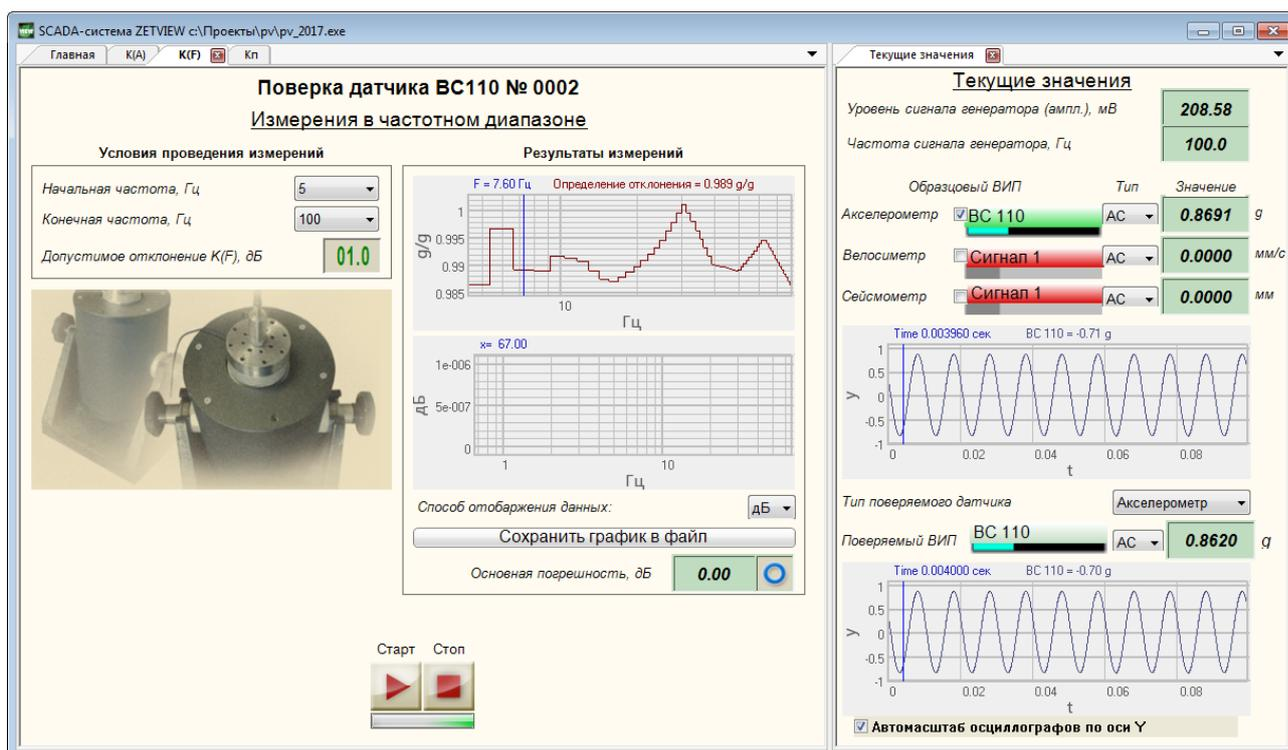
Рисунок 15 – Измерения в частотном диапазоне
