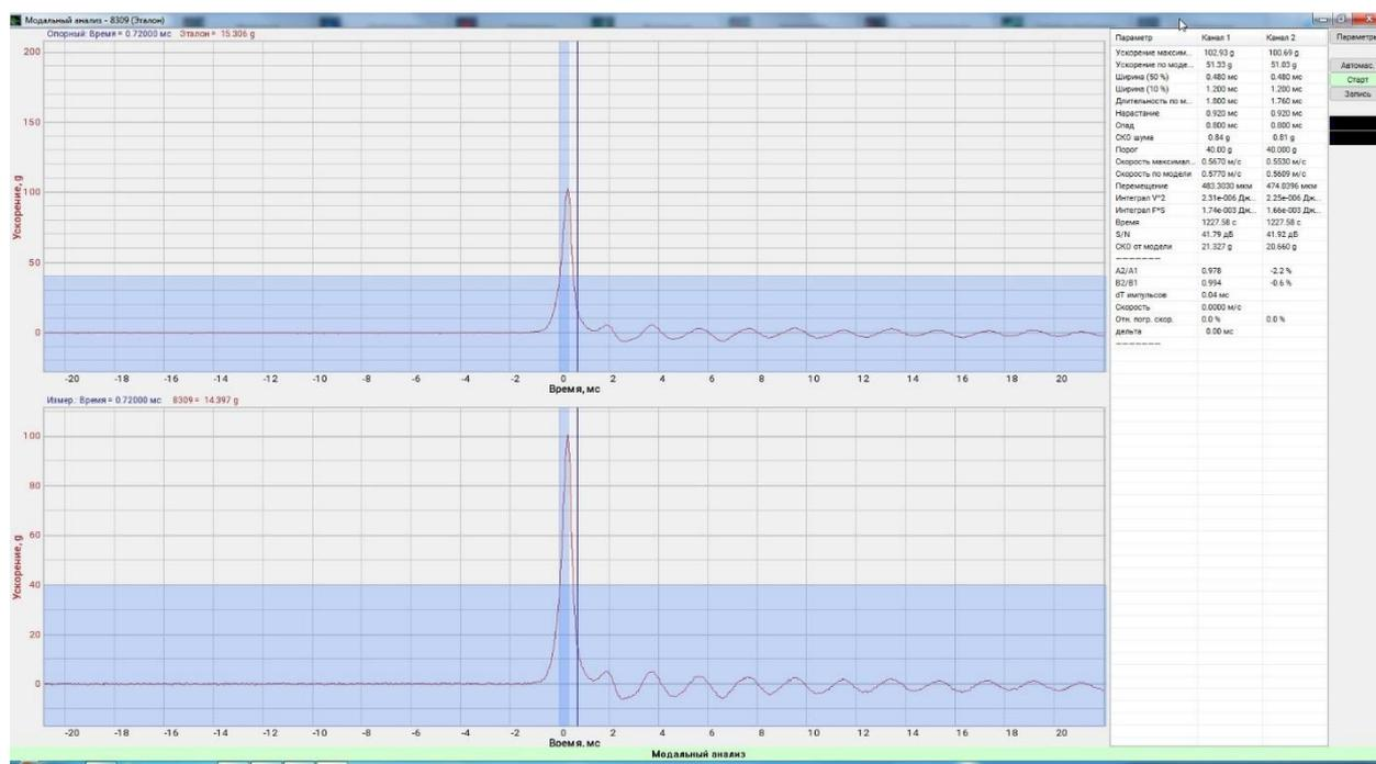
Рисунок 47 - Регистрация ударного импульса в программе "Модальный анализ"
