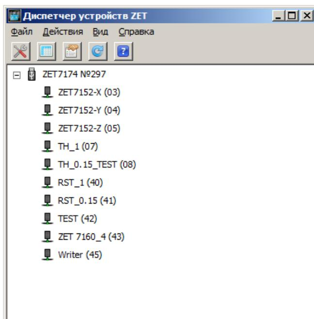
Рис. 2.3 Список устройств, подключенных к ZET 7174
