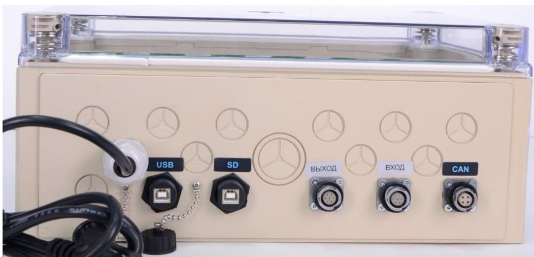
*Рис. 1.6 Внешний вид панели ССО с разъемами*
