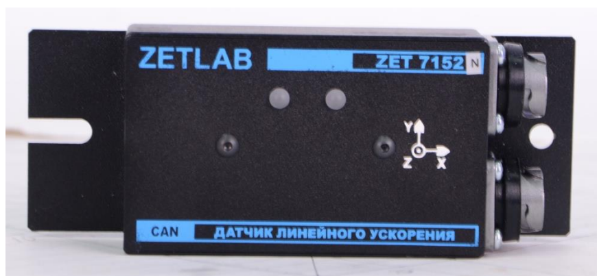
Рис. 1.7 Внешний вид цифрового акселерометра ZET 7152-N
