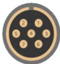
Рис. 1.2 Расположение контактов разъема FQ14-7TJ
