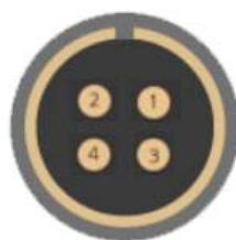
Рис. 1.3 Расположение контактов разъема FQ14-4TJ
