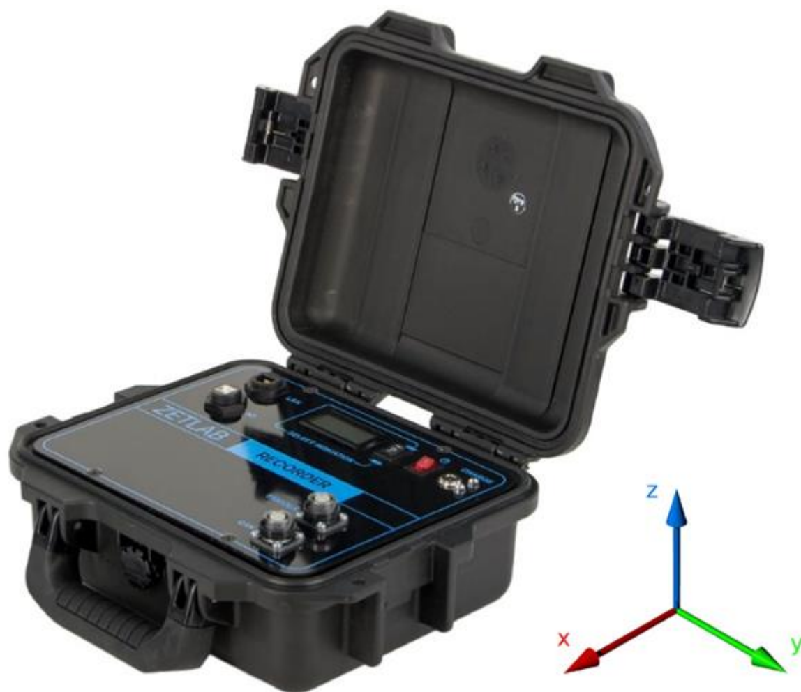
Рис. 1.3 Направление измерительных осей
