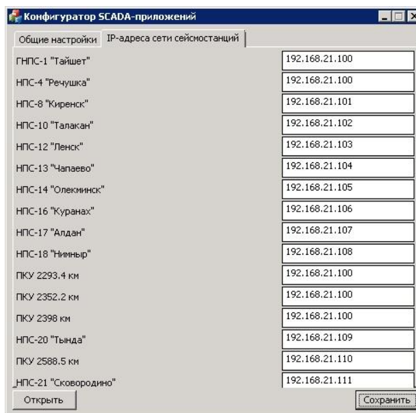
Рис. 6.22. Окно «Конфигуратор SCADA-приложений» вкладка «IP -адреса сети сейсмостанций» с примером IP адресов для сейсмостанций сети СКСВ
