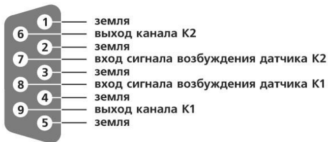
Рисунок 6.2 - Назначение выводов разъема DB-9 (ВЫХОД)
