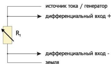
Рисунок 6.8 – Схема подключения с одним измерительным резистором R_1 (четвертьмостовая схема)
