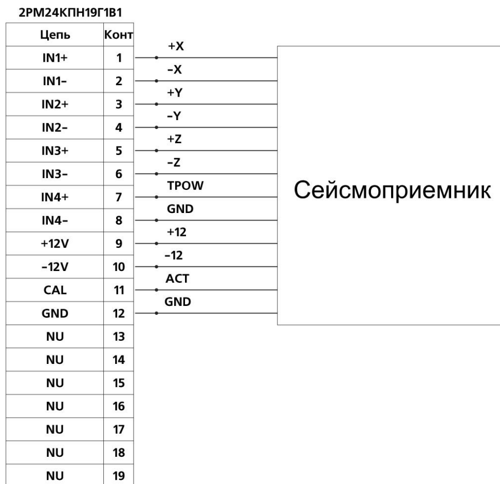
Рисунок Б.1 — схема соединения разъема 2PM24КПН19Ш1В1 с кабелем сейсмоприемника.
