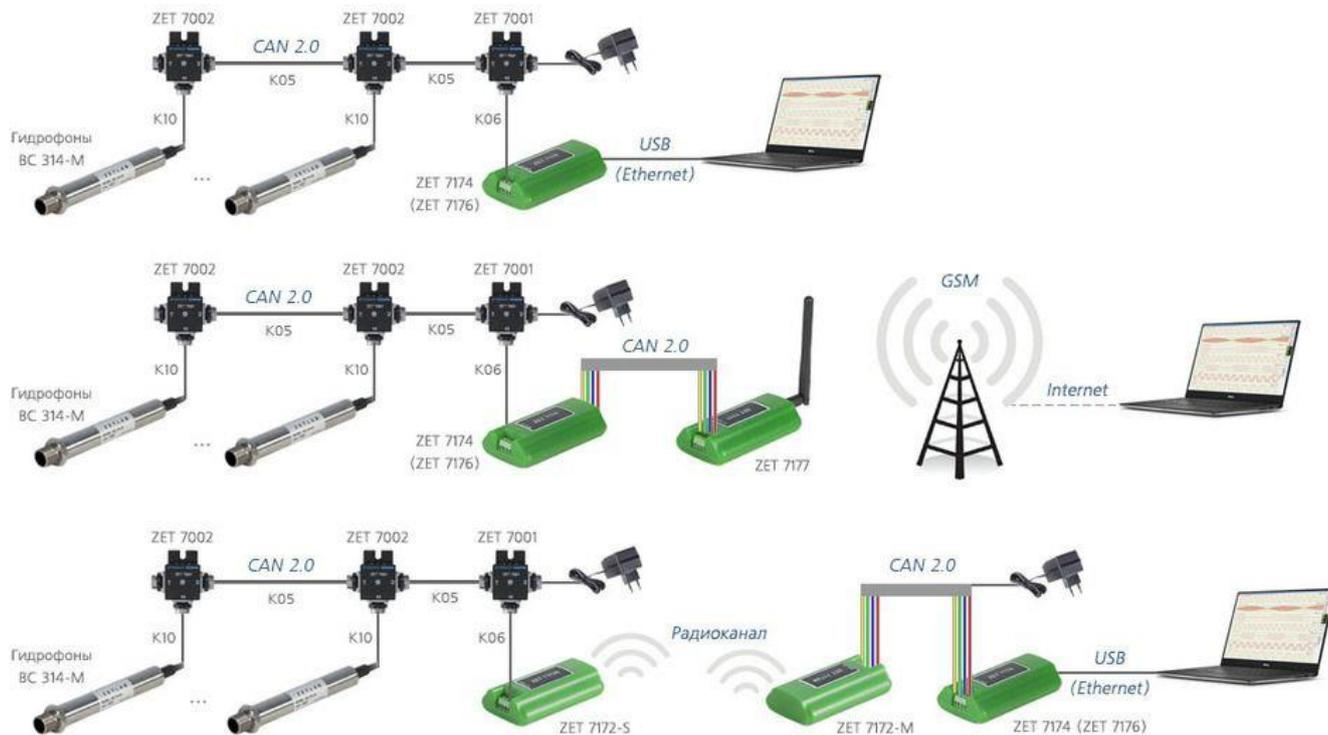
Рис. 2.3 Схема подключения
