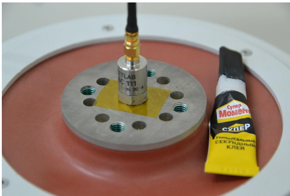
Рис. 3.3 Крепление акселерометра на клей
