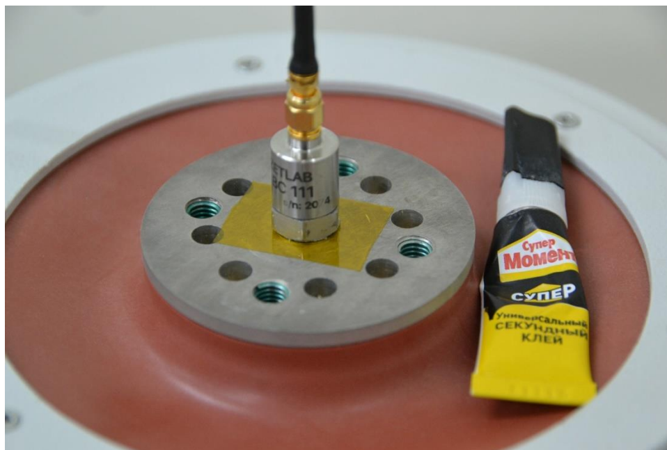
Рис. 3.3 Крепление акселерометра на клей
