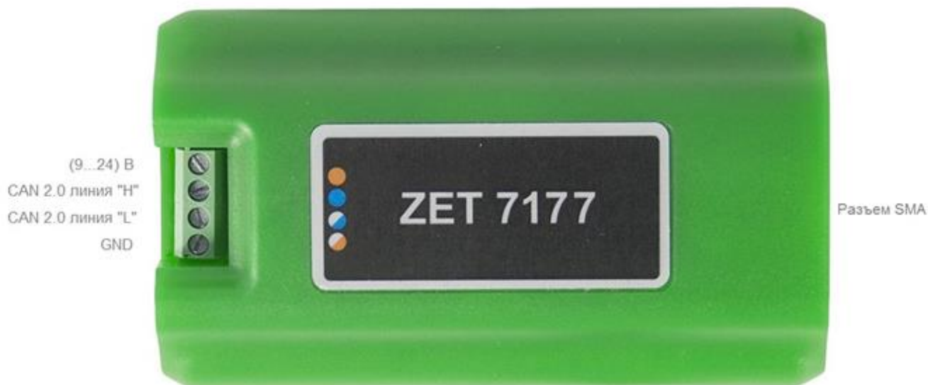
Рис. 2.3 Обозначение контактов ZET 7177 в лабораторном исполнении
