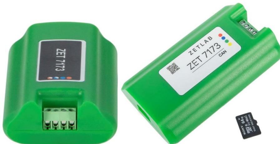
*Рис. 2.1 Внешний вид автономного регистратора в лабораторном исполнении*
