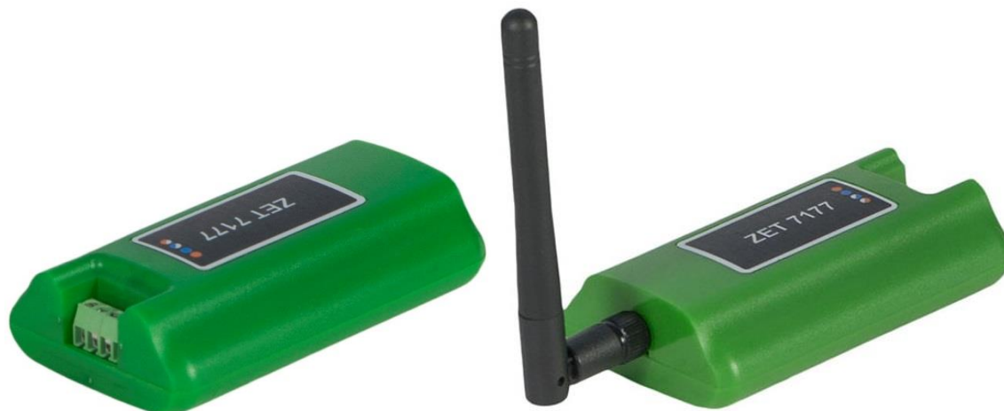
Рис. 2.1 Внешний вид преобразователя интерфейса в лабораторном исполнении
