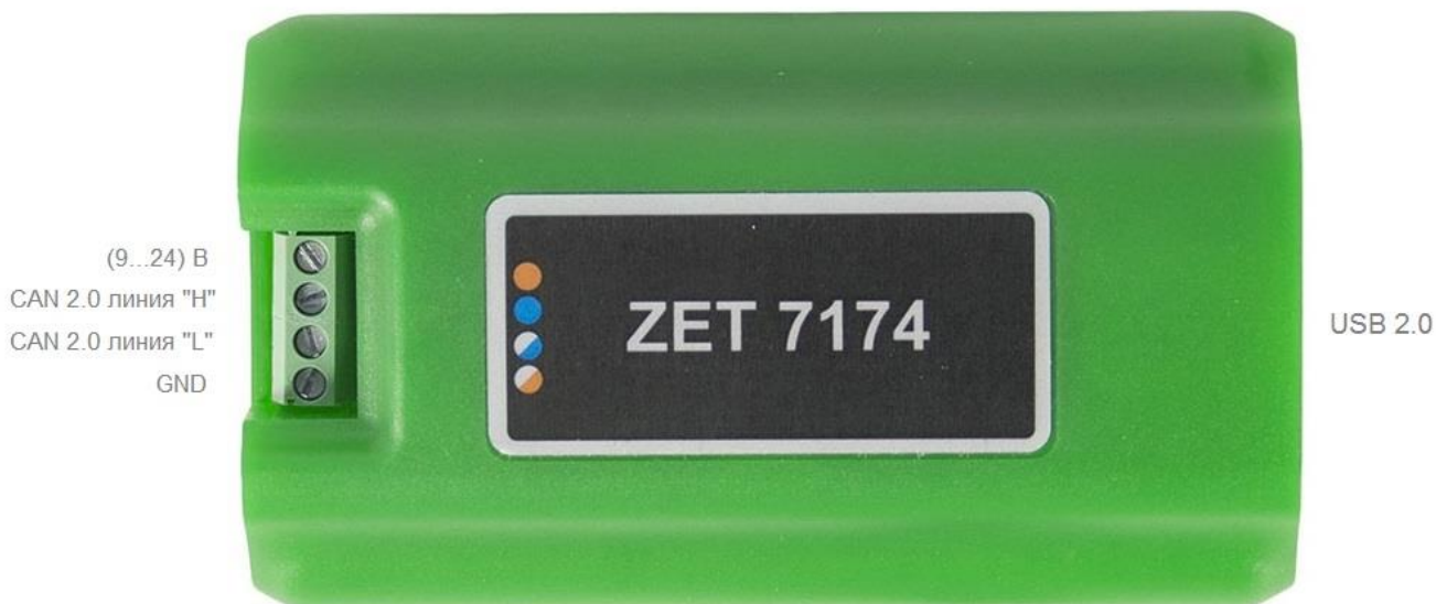
Рис. 2.3 Обозначение контактов ZET 7174 в лабораторном исполнении
