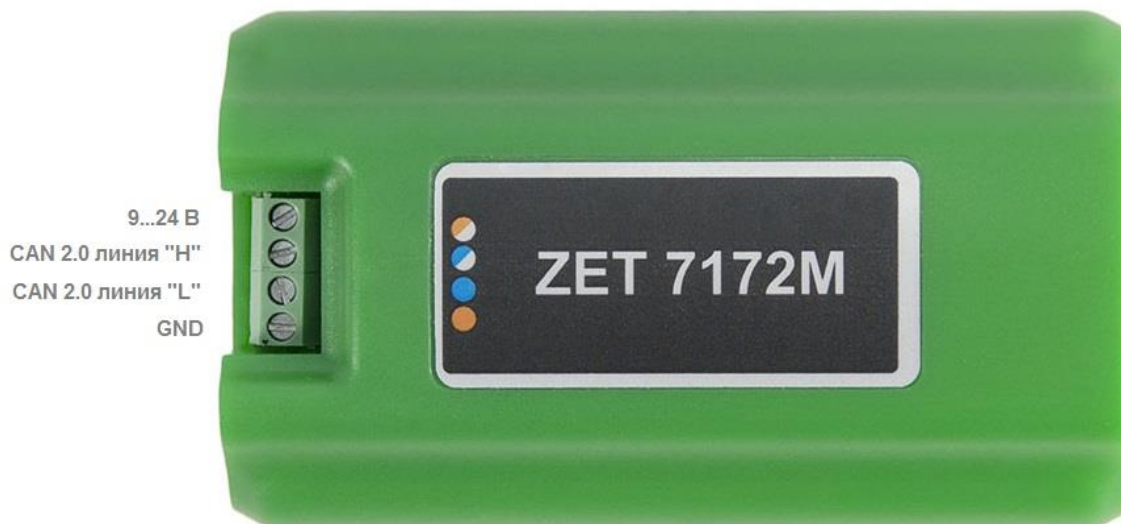
Рис. 2.3 Обозначение контактов ZET 7172-M и ZET 7172-S в лабораторном исполнении
