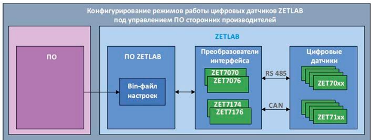
Рисунок 63. Схема взаимодействия при конфигурировании цифровых датчиков
