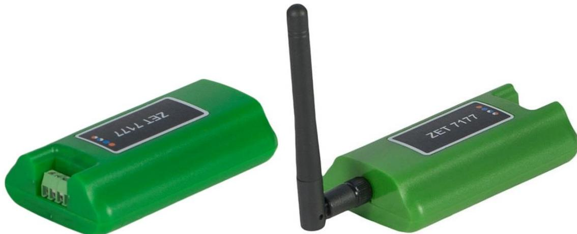
Рис. 2.1 Внешний вид преобразователя интерфейса в лабораторном исполнении
