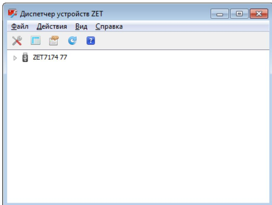
*Рис. 3.2 Мастер ZET 7174 в программе «Диспетчер устройств ZET»*
