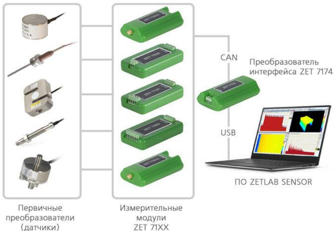
Рис. 2.4 Схема подключения
