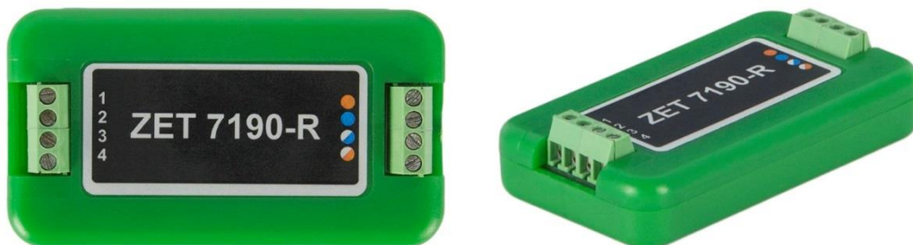
Рис. 2.1 Внешний вид регулятора ZET 7190-R в лабораторном исполнении
