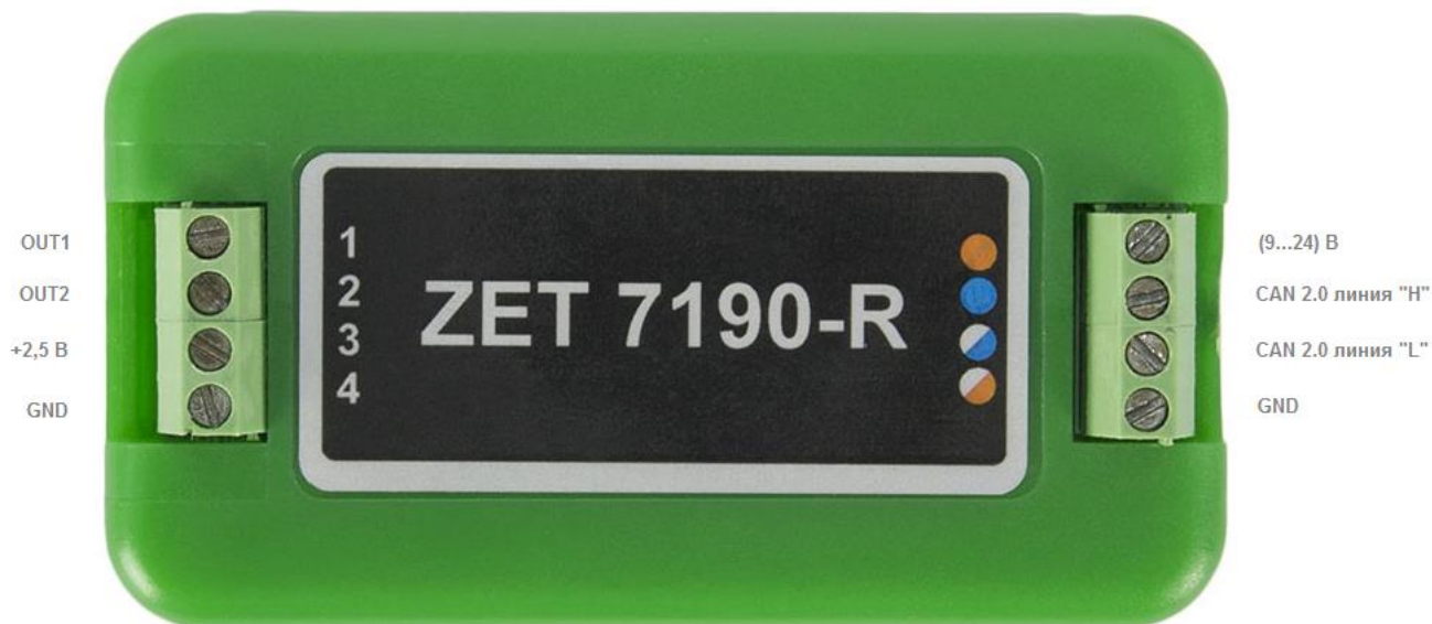
Рис. 2.3 Обозначение контактов ZET 7190-R в лабораторном исполнении
