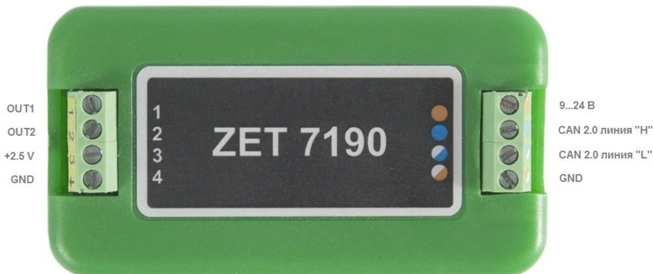
Рис. 2.4 Обозначения клемм ZET 7190 в лабораторном исполнении
