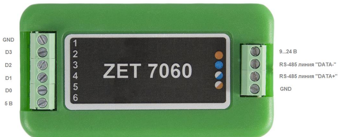
Рис. 2.3 Обозначение клемм ZET 7060 в лабораторном исполнении
