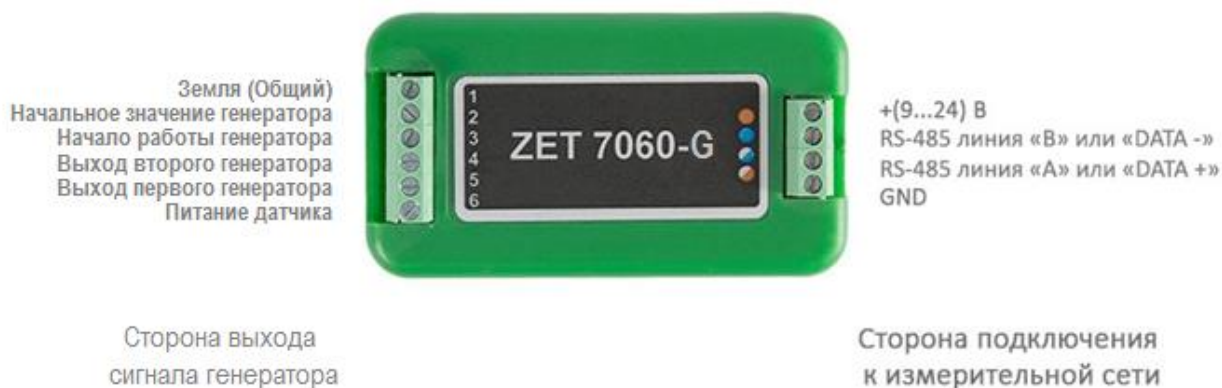
Рис. 2.3 Обозначение клемм ZET 7060-G в лабораторном исполнении
