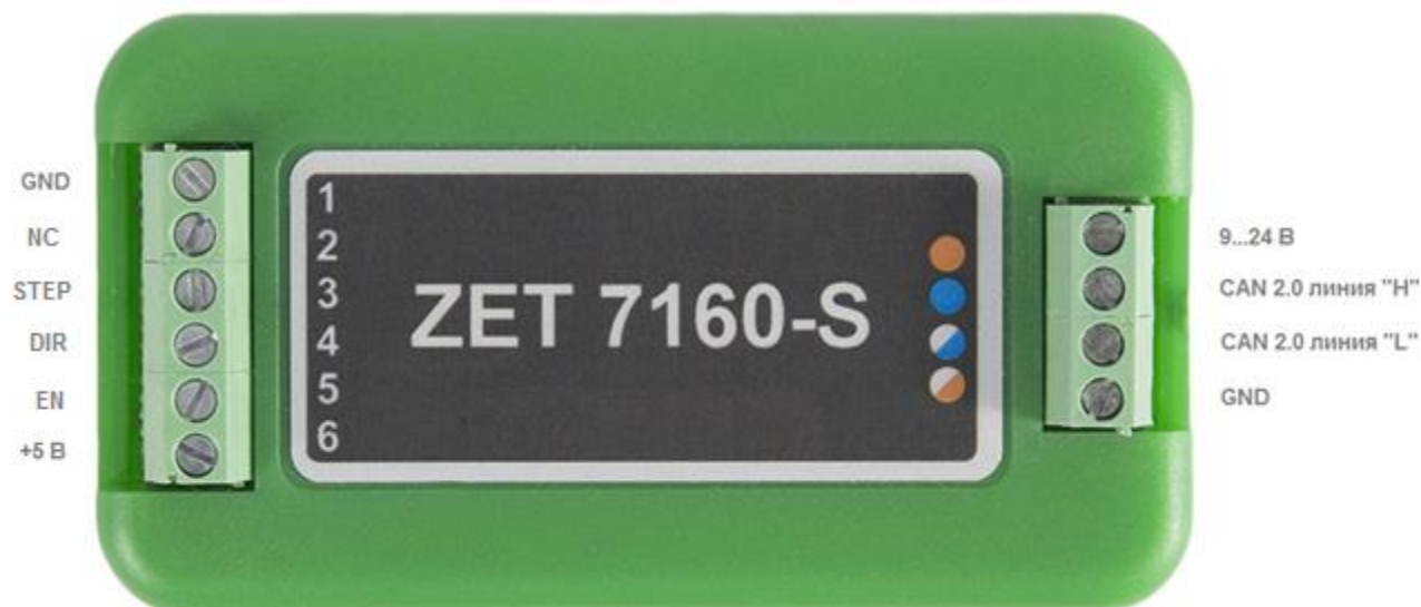
Рис. 2.4 Обозначения клемм ZET 7160-S в лабораторном исполнении
