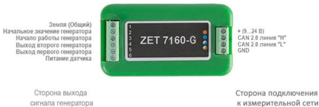
Рис. 2.4 Обозначения клемм ZET 7160-G в лабораторном исполнении
