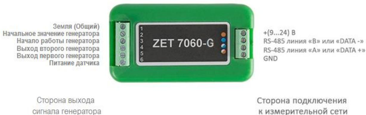
Рис. 2.3 Обозначение клемм ZET 7060-G в лабораторном исполнении
