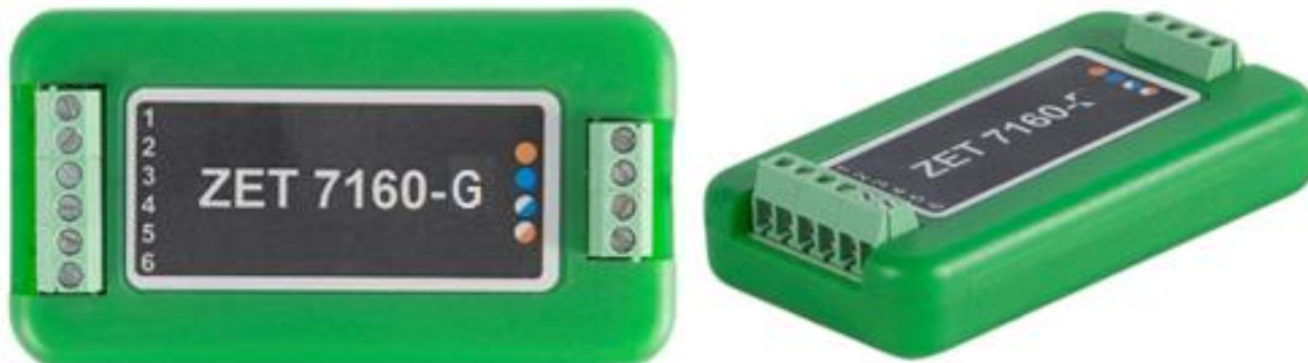
Рис. 2.1 Внешний вид цифрового генератора в лабораторном исполнении
