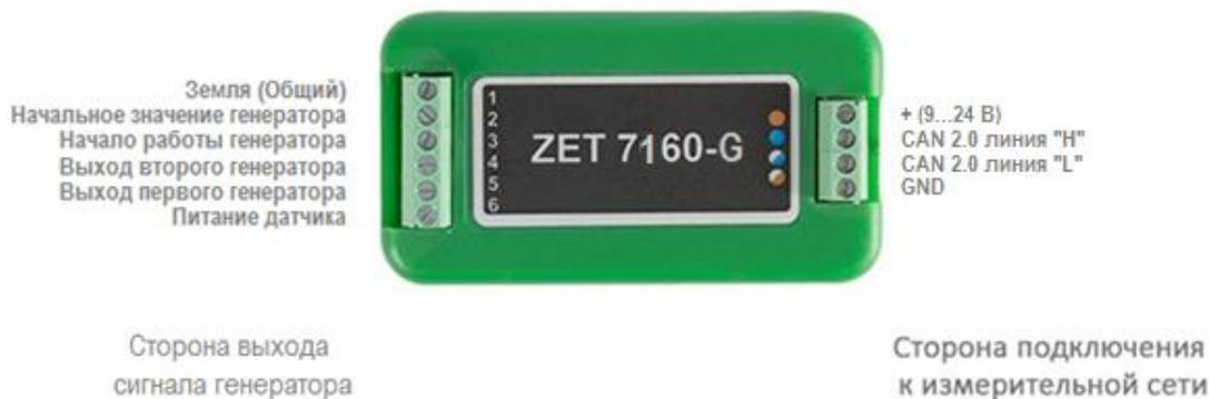
Рис. 2.4 Обозначения клемм ZET 7160-G в лабораторном исполнении
