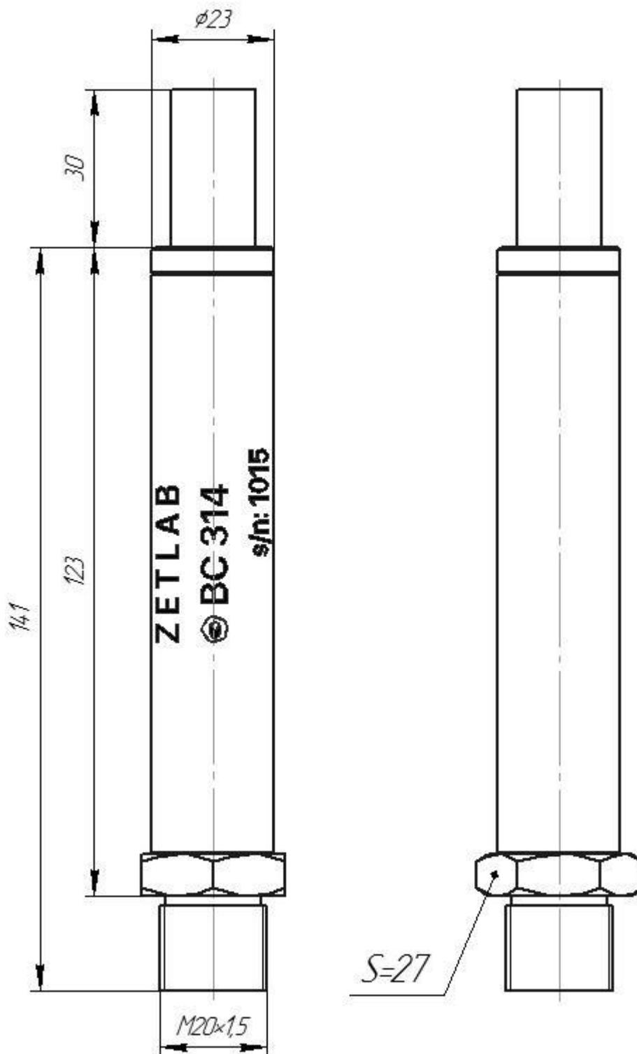
Рис. 3.1 Габаритный чертеж
