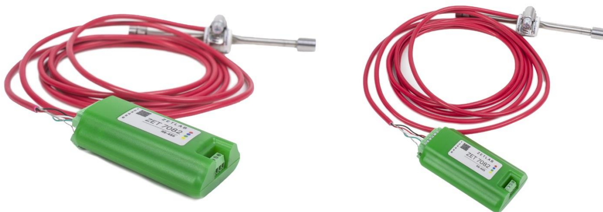
Рис. 2.1 Внешний вид регистратора в лабораторном исполнении с подключенным к нему струнным датчиком деформации
