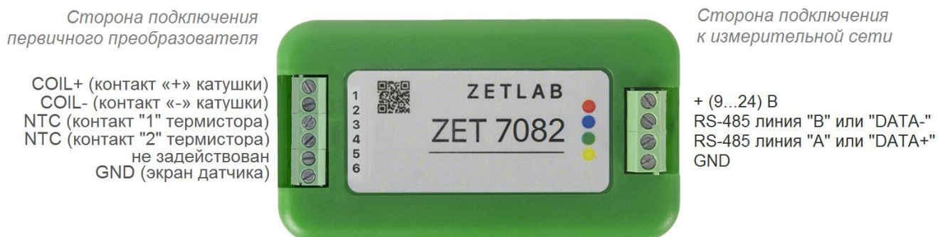
Рис. 2.3 Обозначение клемм ZET 7082 в лабораторном исполнении
