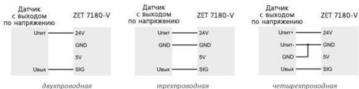
Рис. 2.5 Схемы подключения датчиков с выходом по напряжению
