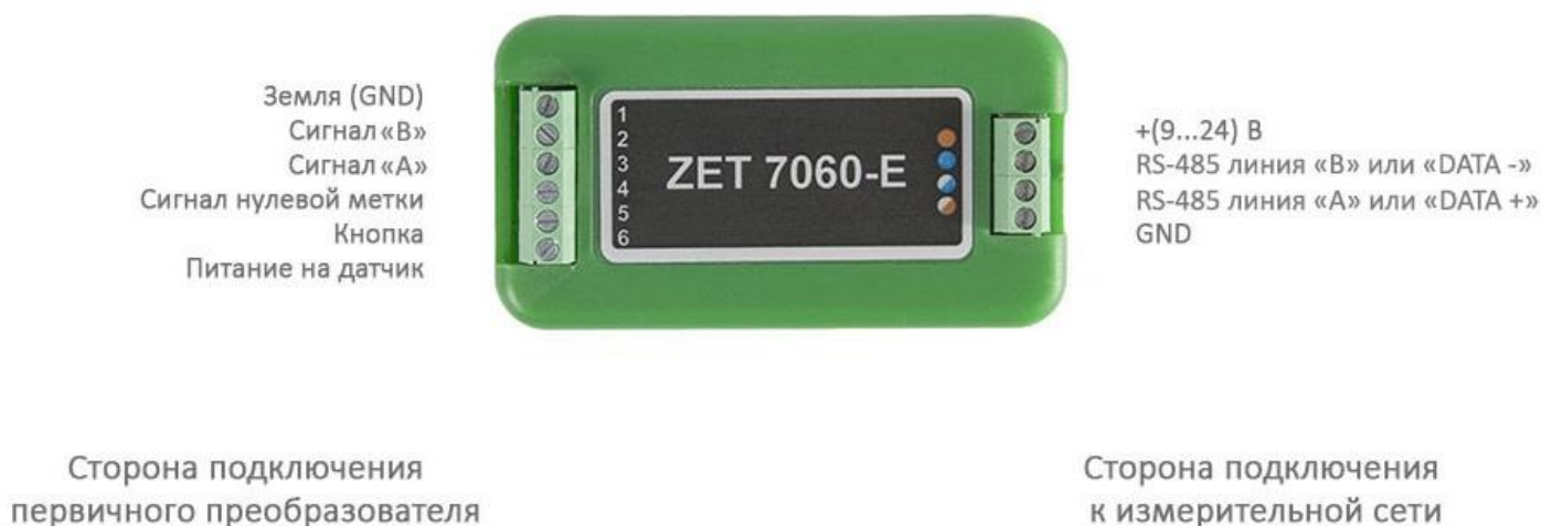
Рис. 2.3 Обозначение клемм ZET 7060-Е в лабораторном исполнении
