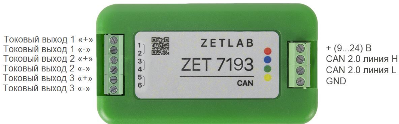
Рис. 2.3 Назначение разъемов преобразователя интерфейса ZET 7193
