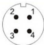
Рис. 2.2 Вид на разъем датчика со стороны сочленения
