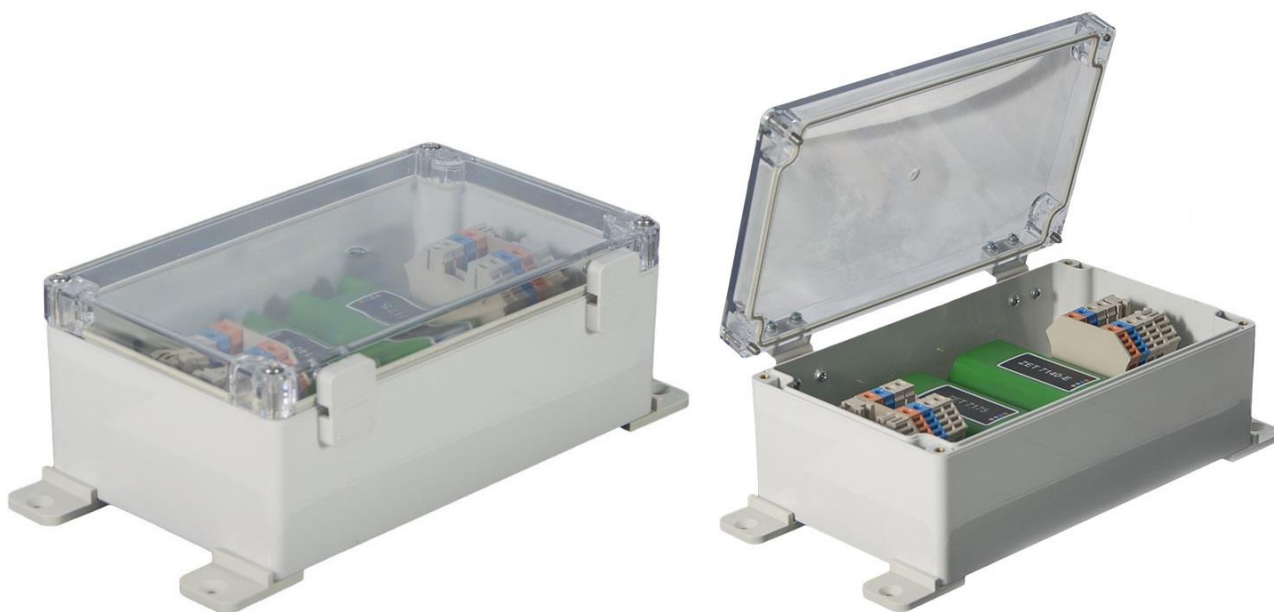
Рис. 2.2 Внешний вид цифрового датчика ZET 7151 в промышленном исполнении
