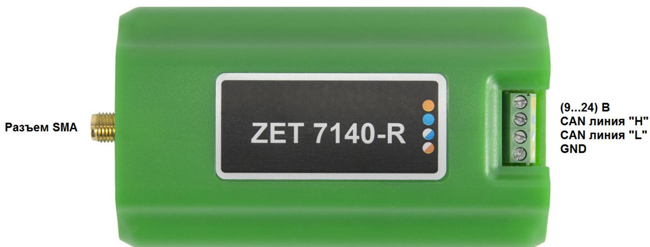
Рис. 2.4 Обозначение контактов ZET7140-R в лабораторном исполнении
