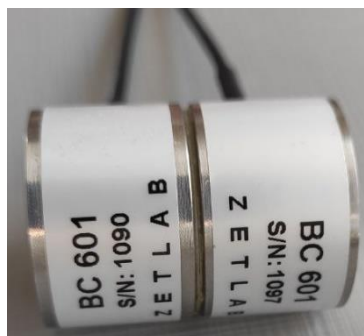
Рис. А2 Склеивание контактной поверхности датчиков акустической эмиссии ВС 601
