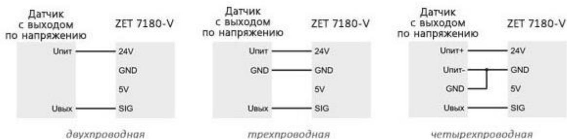
Рис. 2.5 Схемы подключения датчиков с выходом по напряжению
