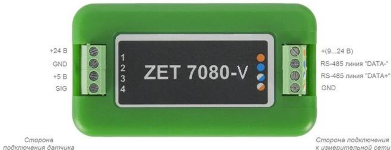
Рис. 2.3 Обозначение разъемов ZET 7080-V в лабораторном исполнении
