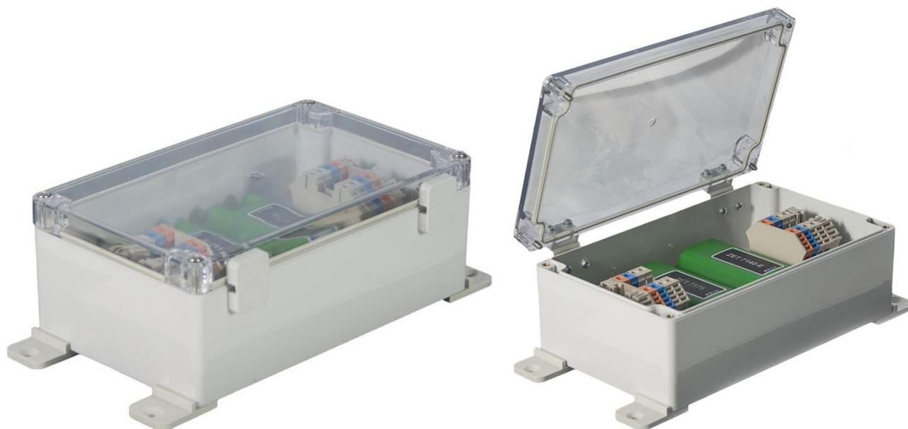
*Рис. 2.2 Внешний вид цифрового энкодера в промышленном исполнении*
