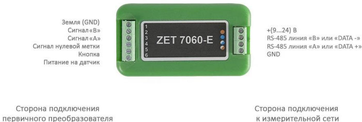
Рис. 2.3 Обозначение клемм ZET 7060-Е в лабораторном исполнении
