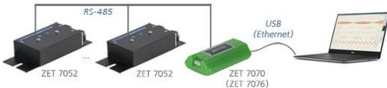
Рис. 2.4 Схема подключения
