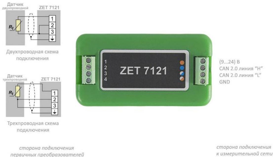
Рис. 2.4 Обозначение контактов ZET 7121 в лабораторном исполнении
